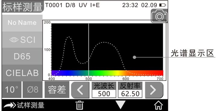
图8 反射率光谱测量界面
