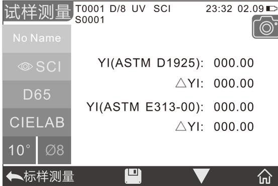
图38 试样测量界面下的黄度指数界面
