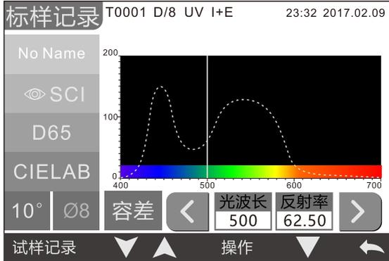
图19 标样记录反射率光谱图界面
