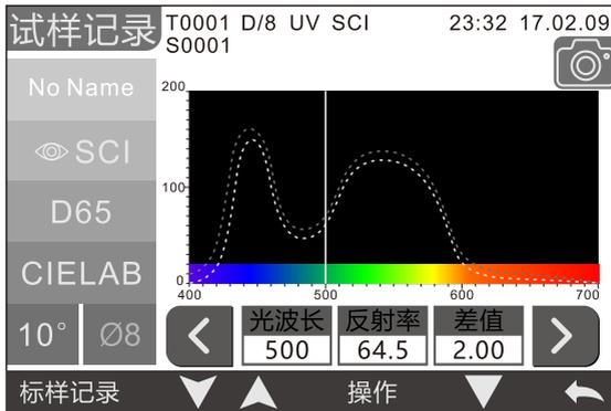
图24 试样记录反射率光谱图界面
